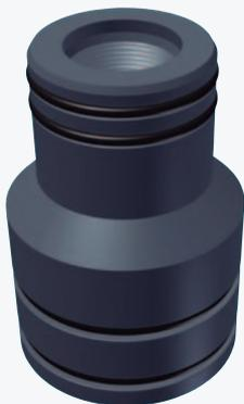
Roscado de cuello extendido para terminación simple, sella el espacio anular mediante 2 O-rings que sellan el pasaje de producción entre el colgador y la brida bonete o adaptadora. Tienen preparación interior para alojar una válvula de contra presión tipo H y las roscas colgadora y de maniobra son fabricadas de acuerdo a las especificaciones del cliente.
