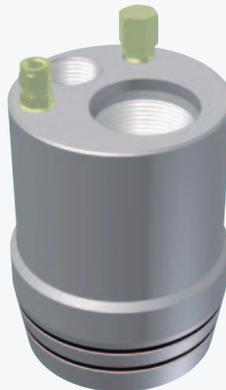
Sella en espacio anular mediante dos o-ring robustos. En la parte superior posee un perfil cilíndrico sobre el cual sellan 2 O-rings alojados en la brida integral empaquetadora. Tiene preparación para alojar válvula de contrapresión tipo H. Está preparado para realizar pruebas de hermeticidad en la empaquetadura de los cables de la BES.
