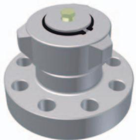
Fabricadas de acuerdo a la norma API 6A, con roscas internas UPTBG – EUE. Se proveen con conexión inferior roscada o bridad y tapa de ajuste a golpe que permite su fácil apertura para intervenir el pozo. Posee conexión de 1/2" para colocar manómetro.
