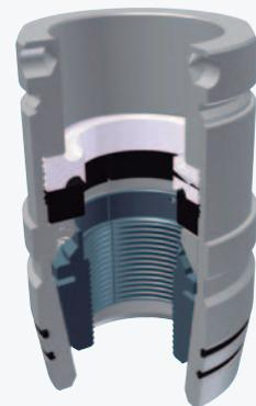
Diseñado para ser instalado en cabezas colgadoras tanto de perfil cónico como cilíndrico. El cuerpo adaptador, anillos y mordazas forman un conjunto simple y único. El anillo empaquetador tiene refuerzos de tela anti-extrusión en su diámetro interior.
